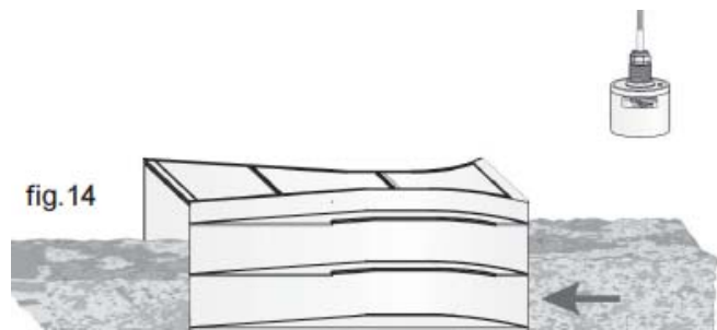
Misura di portata in canali aperti con stramazzi o canali venturi, la funzione può essere gestita solo via unità SWING
